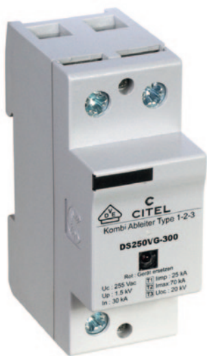
■ Obr. 1 Kombinované svodiče přepětí DS250VG-300, typ 1+2+3
